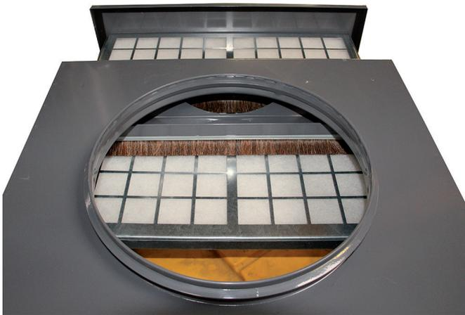
In dem GeoFilter Dust sind zwei separaten Bürsten eingebaut, die das Filter bei Auswechslung reinigen. Beim Filterwechseln ist das filtrierte Material gemäß geltender Gesetzgebung zu entsorgen. Das GeoFilter Dust ist aus pulverlackiertem, galvanisiertem Stahl ausgeführt.
