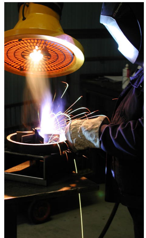
Wing armen kan tilbydes med indbygget lys, start/stop kontakt, manuelt eller motoriseret spjæld
