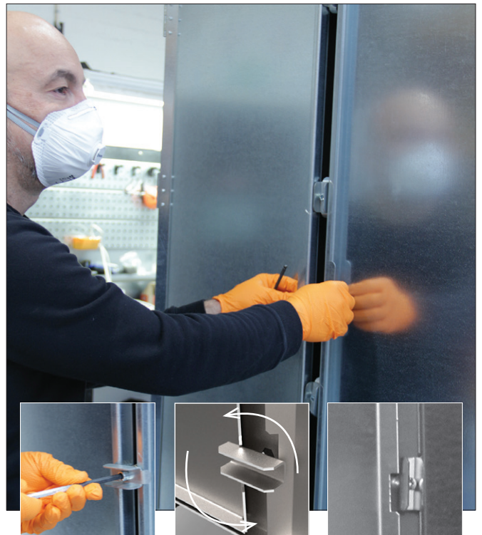
1. Lösen Sie die Schrauben mit einem Inbusschlüssel.
