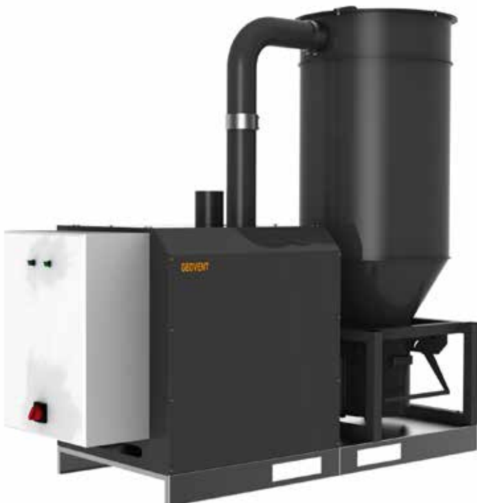
HVU - vollautomatisches Absaug- und Filtersystem mit Druckluftabreinigung. Abscheidegrad ca. 99,9%
