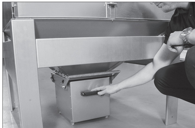
3. Schieben Sie den Eimer gegen den Rücken, während Sie den Griff nach unten drücken.
