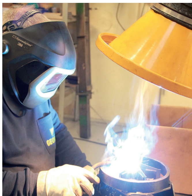
COMPACT arm 1 - 2 m inkl. automatik for automatisk start/stop af ventilator og motorspjæld.
